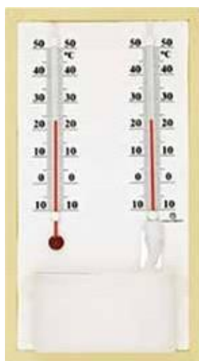
Fig 2-2 – Termômetros de bulbo: seco (TBS) e úmido (TBU)
